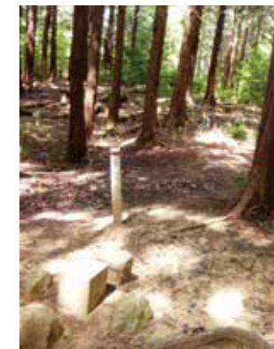
▲三角点は地図を作成するために測量する際に位置の基準となる点です
